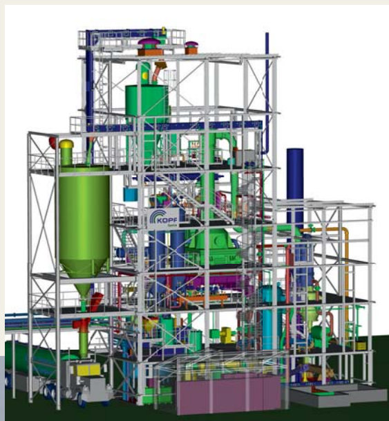
Apparataufstellung der im Jahr 2010 im Bau befindlichen Klärschlammverwertung im Klärwerk Mannheim
